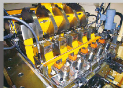
New mechanism allows P.K.O. adjustment. 可變3段行程前通出機構(P.K.O.)，方便模具設計及調整 (選配)
