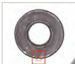
頭裂 Head Crack
